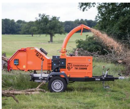
Obr. 32 Drtič s výfukovým komínem [49]
