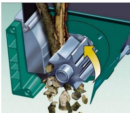
Obr. 9 Princip funkce frézovacího mechanismu s přitlačnou deskou [5]
