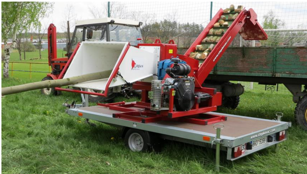
Obr. 34 Odvod materiálu za pomoci dopravníku [51]
