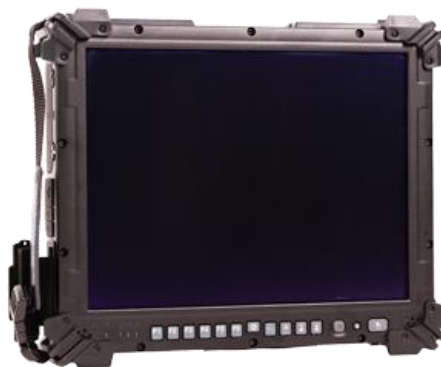
Obrázek 5-2: DE3400 ARINC 429 data analyser, obrázek z [14]
