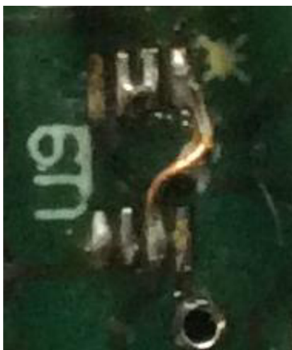
Obrázek 10-7: ATTRACT SPI řešení špatného zapojení logického hradla OR
