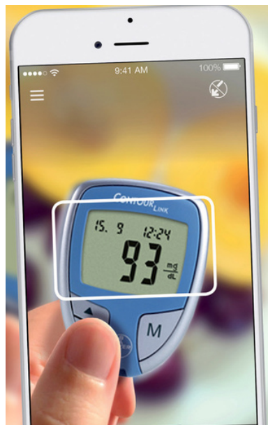
Obr. 6.1: Na obrázku je možnosť vidieť návrh spôsobu zadávania glykémie do zariadenia za pomoci rozpoznávanie znakov na displeji glukometra(OCR). Z mnoho glukometrov je možné zistiť čas merania, dátum a hodnotu.
