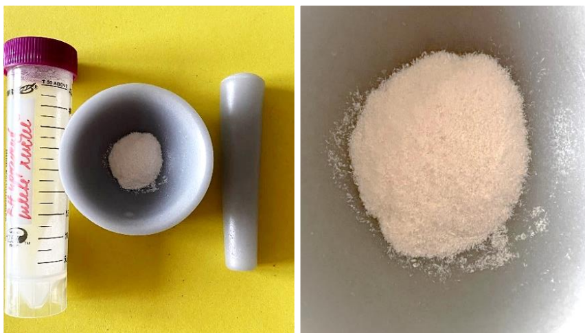
Obrázek 23: Korundová miska s tloučkem (vlevo) a výstupní materiál po ručním mletí (vpravo)
