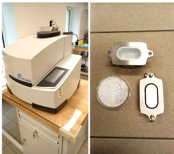
Obrázek 24: Kulový mlýn Emax se součástmi – mlecí miska a mlecí kuličky (vlevo) a výstupní materiál (vpravo)
