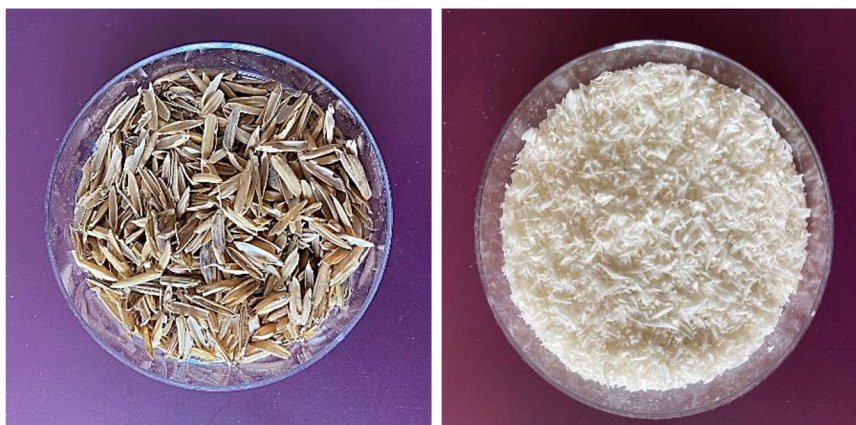
Obrázek 18: Rýžové slupky surové (vlevo) a po úpravě (vpravo). Upravené rýžové slupky byly použity jako vstupní materiál pro ruční mletí a mletí
