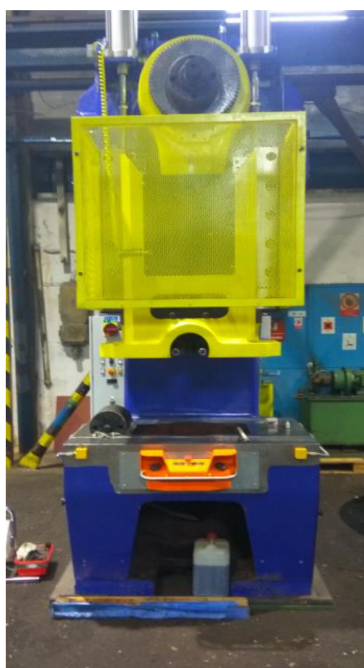
Obr. 2 Excentrický lisu s tlačnou silou 400 t. Obr. 3 CNC excentrický lisu s tlačnou silou 250 t.
