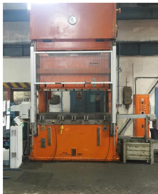
Obr. 2 Excentrický lisu s tlačnou silou 400 t. Obr. 3 CNC excentrický lisu s tlačnou silou 250 t.
