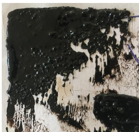
Obrázek 19 - Zrníčka SBS v pojivu
