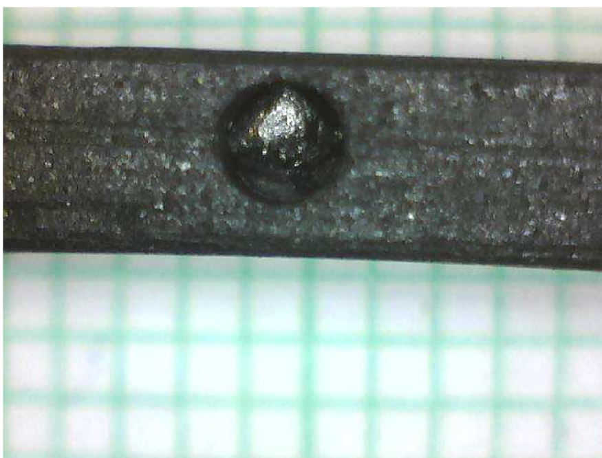
Obr. 11: Snímek z příručního USB mikroskopu. Je zde vidět grafitový trámek s vloženým a částečně roztaveným kouskem palladiového drátku. Trámek je položený na milimetrovém papíře pro lepší srovnání měřítka velikosti.
