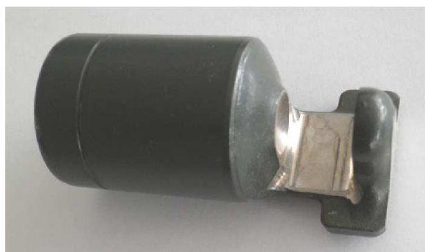
Obr. 3.14d Finální píst potažený vrstvou teflonu
