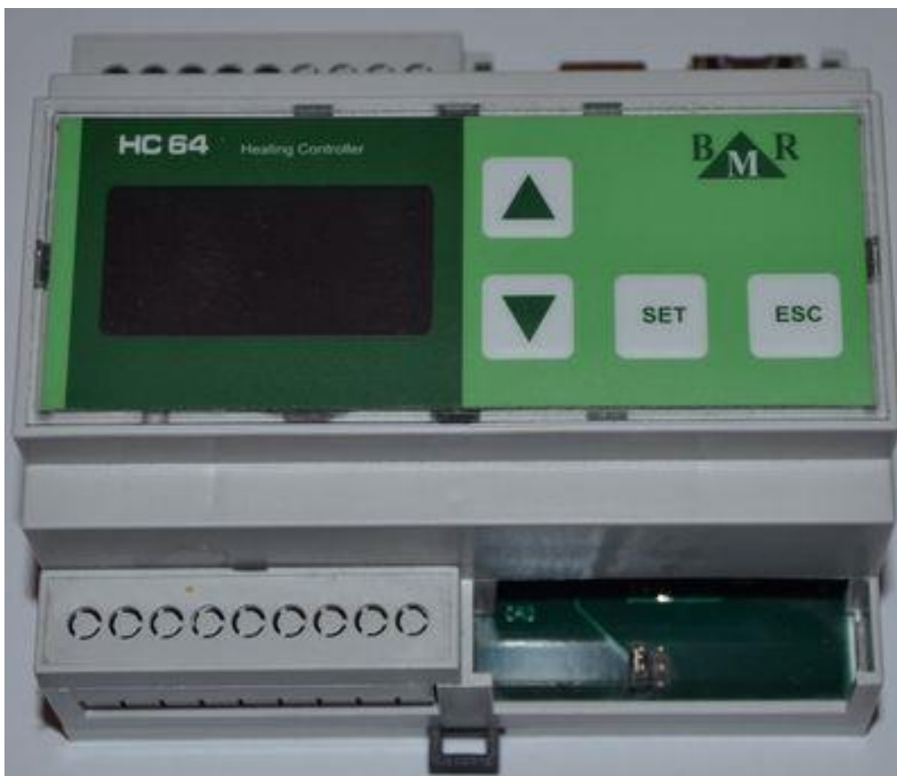
Obrázek 2 Řídicí jednotka HC64 [zdroj: vlastní]
