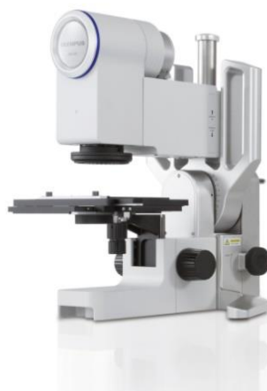
Obr. 3-15 Mikroskop Olympus DSX 500
