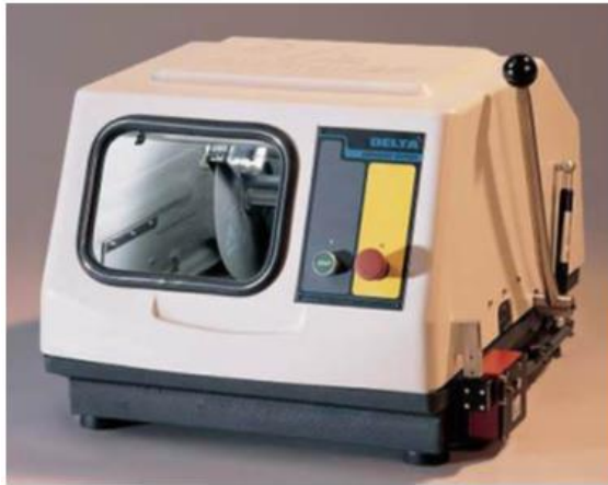
Obr. 3-16 Rozbrušovací kotoučové pila Obr. 3-17 Bruska a leštička Delta AbrasiMet PHOENIX 400
