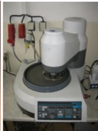
Obr. 3-16 Rozbrušovací kotoučové pila Obr. 3-17 Bruska a leštička Delta AbrasiMet PHOENIX 400
