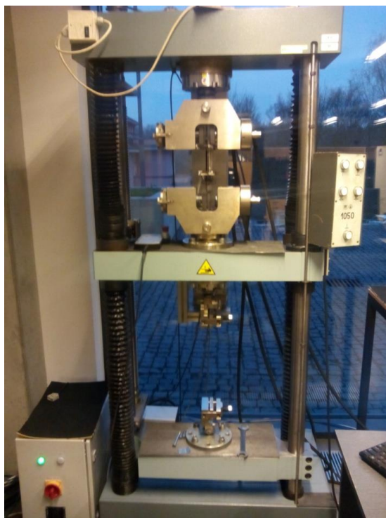
Obr. 3-5 Trhací zařízení TIRA test 2300
