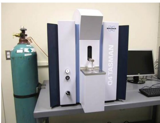
Obr. 3-3 Spektrometr Q4 Tasman
