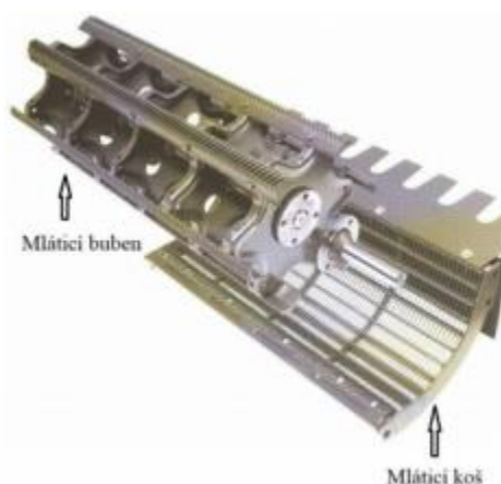
Obrázek 1.3 Jednobubnové mláticí ústrojí (agroportal24h.cz, 2019)
