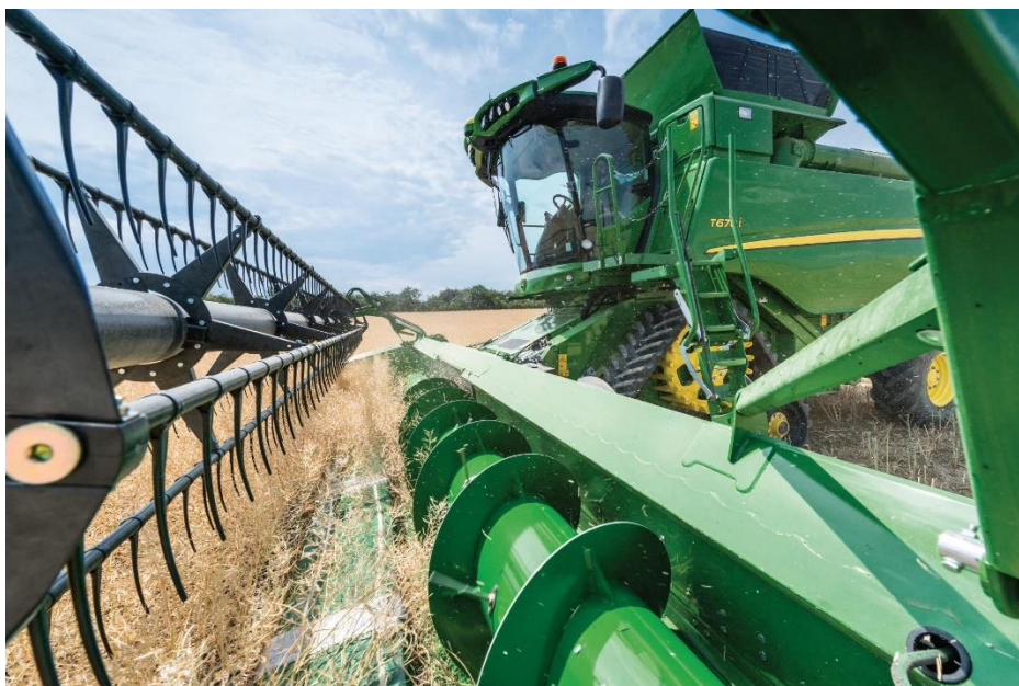
Obrázek 1.2 Šnekový dopravník sklízecí mlátičky (strom.cz, 2017)
