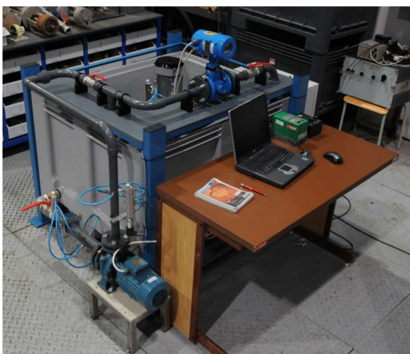
Obr. 5.2 Fotografie univerzální měřicí tratě malých čerpadel
