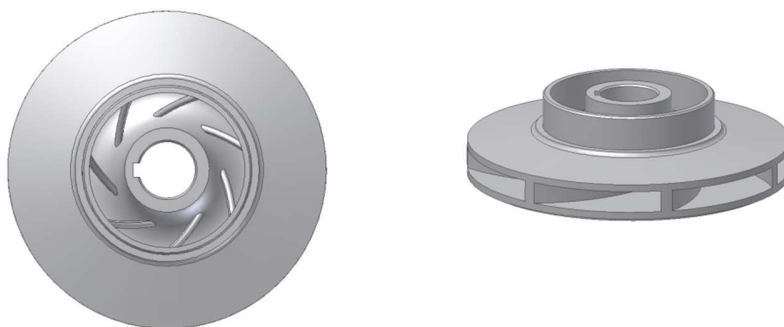
Obr. 4.2 Obrázky radiálně-axiálního kola navrženého na průtok Q = 1,83 l/s ve 3D
