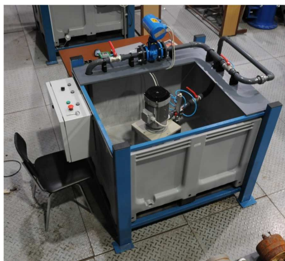
Obr. 5.2 Fotografie univerzální měřicí tratě malých čerpadel
