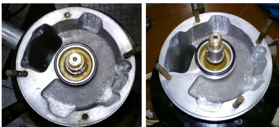
Obr. 3.13 Fotografie upravené axiální spirály čerpadla
