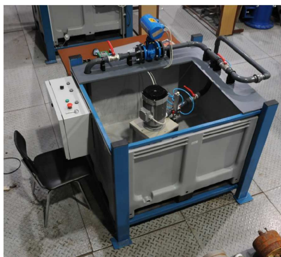
Obr. 5.2 Fotografie univerzální měřicí tratě malých čerpadel
