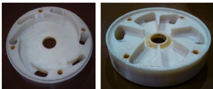
Obr. 3.10 Fotografie vytištěného difuzoru s trojm tvarováním lopatek
