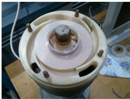
Obr. 5.7 Fotografie z výměny hydraulických částí čerpadla COSU
