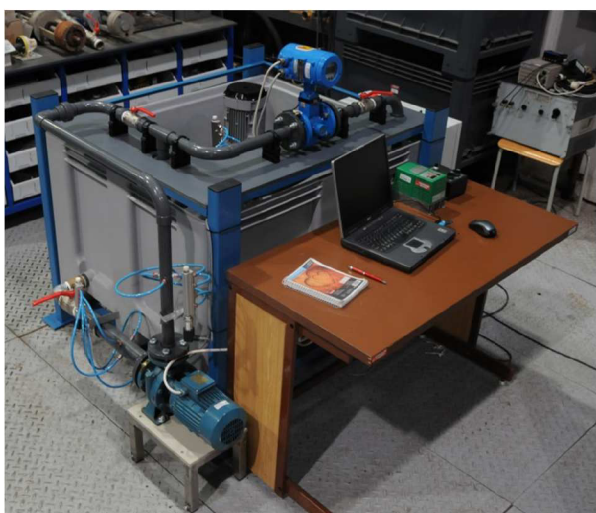
Obr. 5.2 Fotografie univerzální měřicí tratě malých čerpadel
