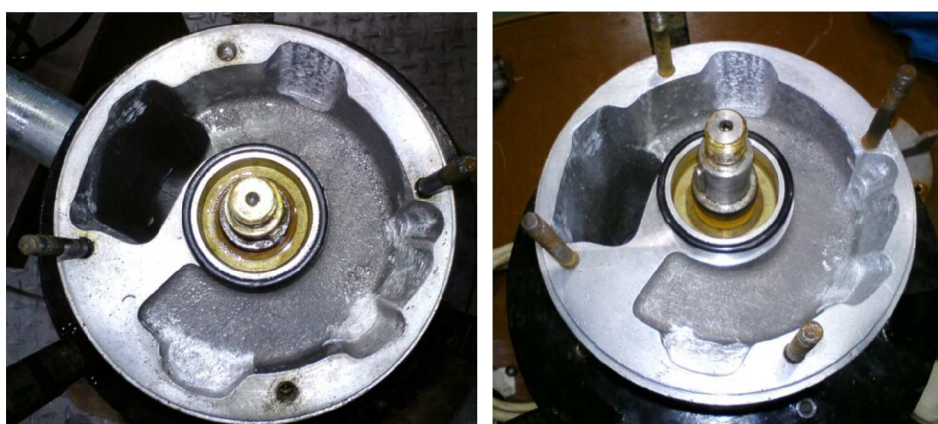
Obr. 3.13 Fotografie upravené axiální spirály čerpadla
