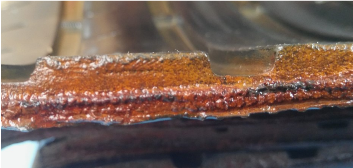
Obr.: 25 Koroze ocelových kordů vzorků umístěných v solném roztoku
