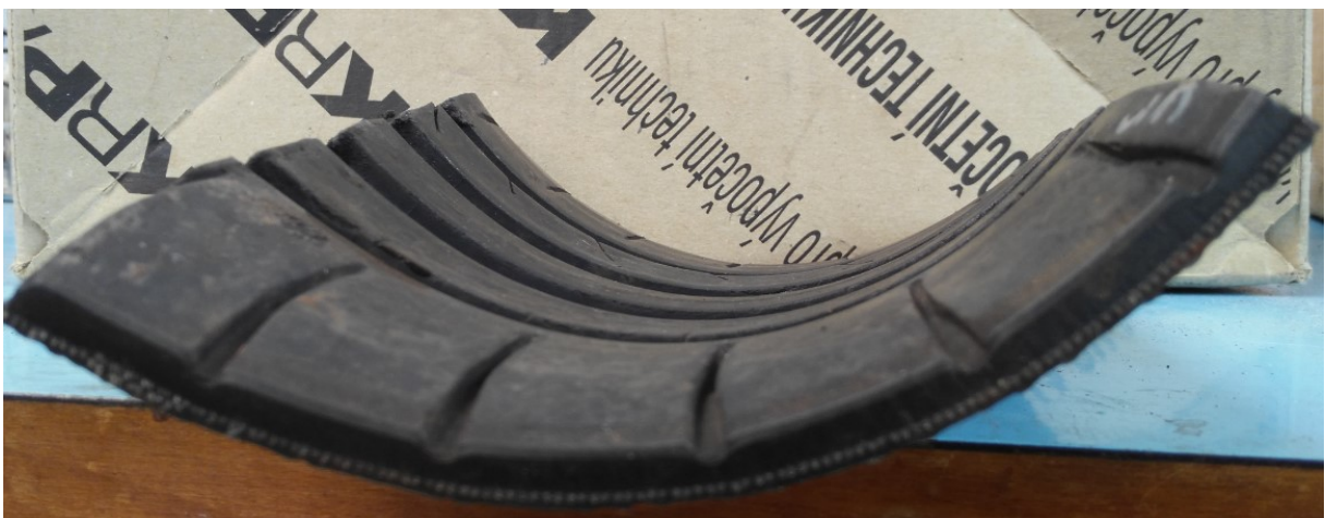
Obr.: 26 Tepelná deformace vzorků z klimatické komory
