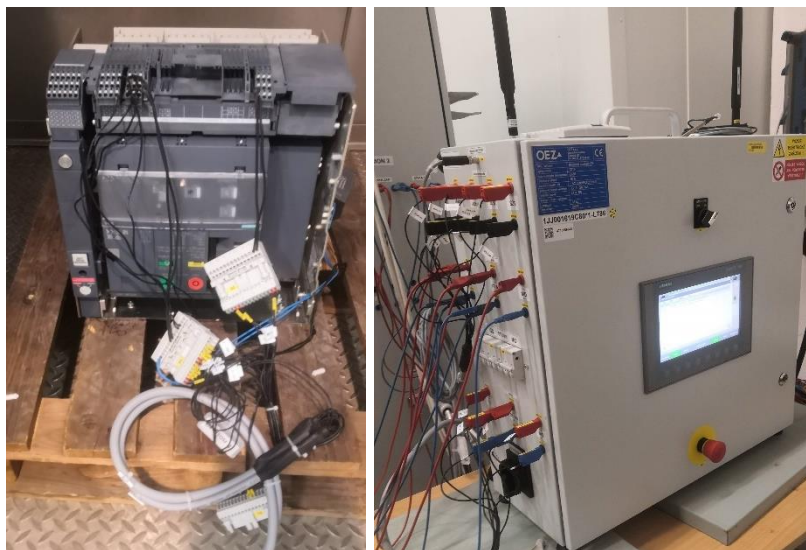
Obrázek 61 – Dílčí zkouška kvality výroby jističe 3WL10
