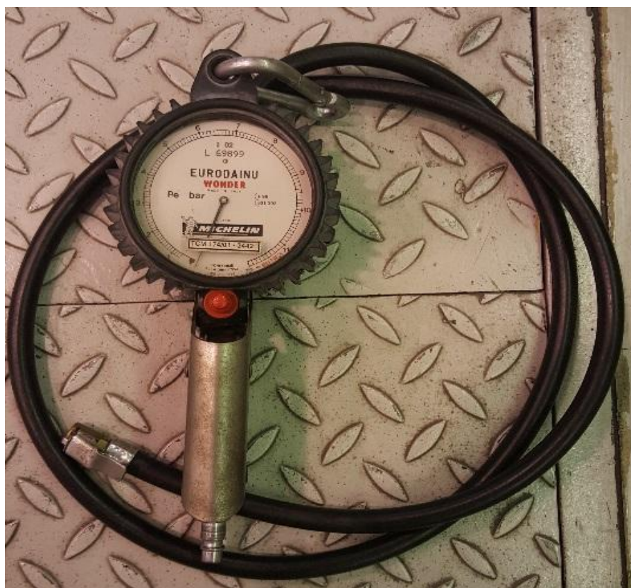
Obr. 17 Měřič tlaku huštění pneumatik Eurodairu, výrobní číslo TCM17/4D1 - 3442
