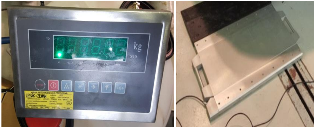
Obr. 18 Váha automobilová přenosná Lesák a Zeman, v. číslo 0801 - L600 - 07
