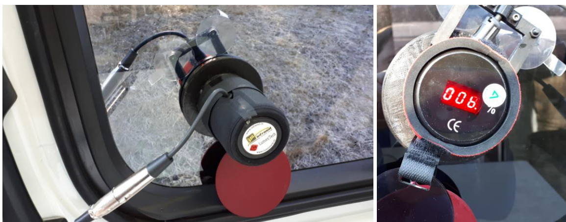
Obrázek č. 29 Měření okna s folií
