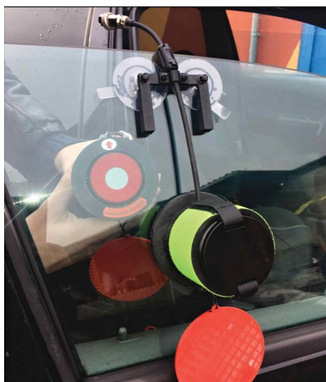
Obrázek č. 19 Pozice umístění vysílače ke sklu vozu [zdroj 13]
