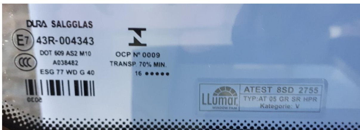
Obrázek č.26 Homologační značka a štítek dodatečné úpravy
