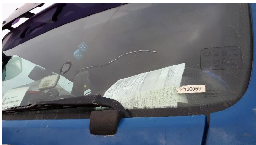
Obrázek č. 38 Poškození větší než 20 mm
