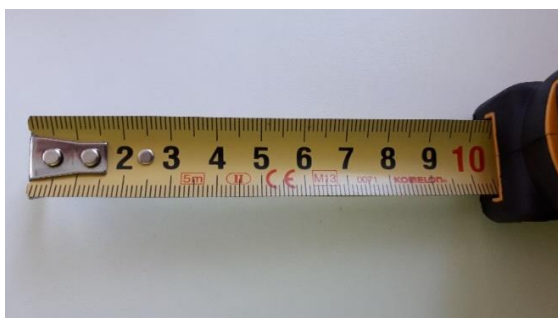
Obrázek č. 32 Údaje na svinovacím metru
