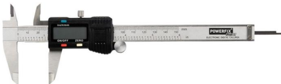
Obrázek č. 33 digitální posuvné měřítko) [zdroj 28]
