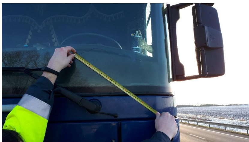
Obrázek č. 36 Měření velikosti poškození zasklení
