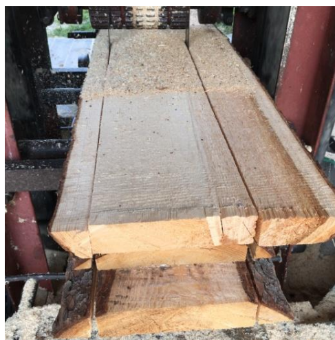
Obrázek 56 - Vyzdravení a začátek omítání
