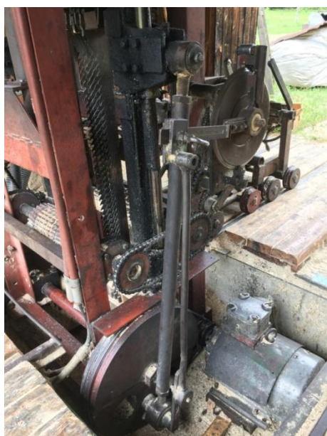
Obrázek 21 - Celkové uložení pohonu pily
