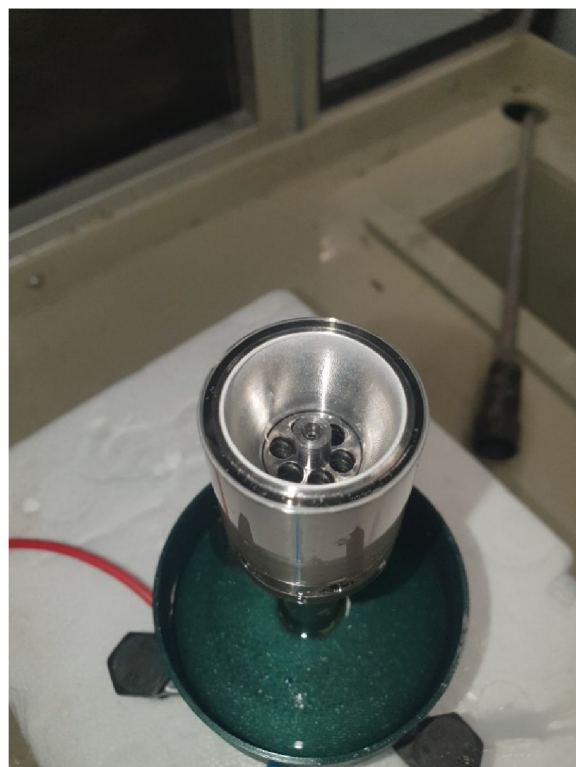
Obrázek 22 Zanášení vnitřního nepřeplaveného prostoru parazitními nanovláknky
