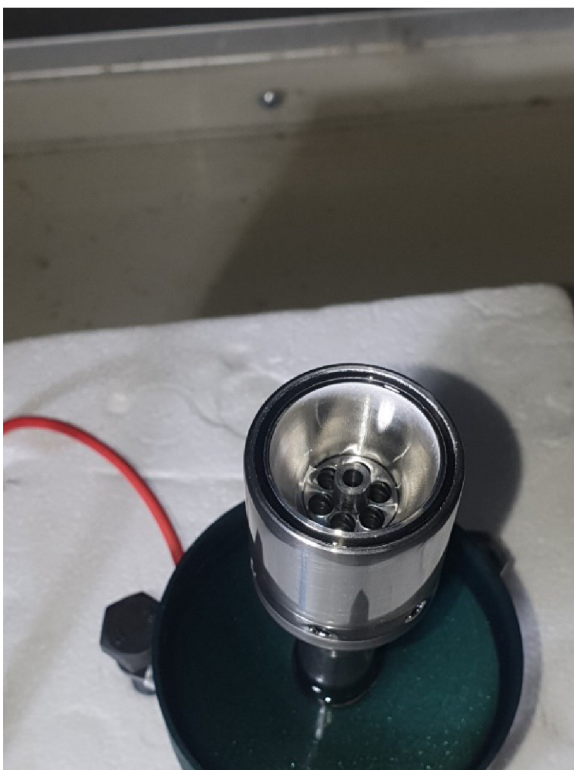
Obrázek 22 Zanášení vnitřního nepřeplaveného prostoru parazitními nanovláknky
