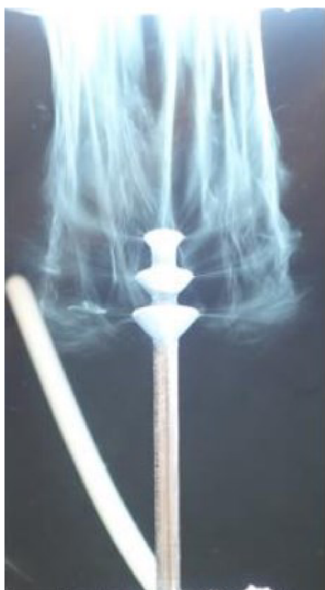
Obrázek 9 Vícetupňová jádrová elektroda vyrábějící nanovláknna., převzato z [11]
