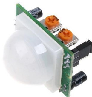
Obrázek 28: PIR senzor - pasivní infračervený senzor pohybu. Zdroj [90]
