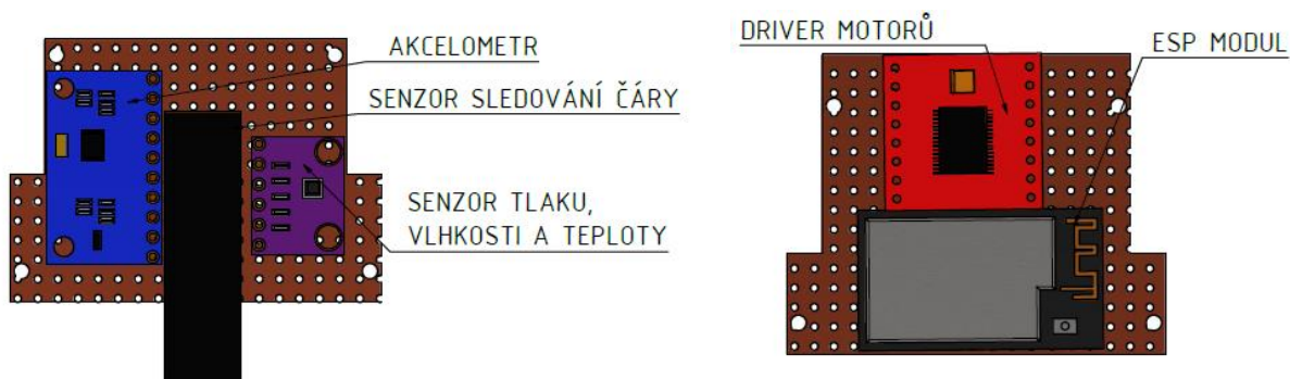
Obr. 5.25 Obsazení desek plošných
