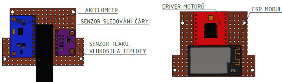
Obr. 5.25 Obsazení desek plošných
