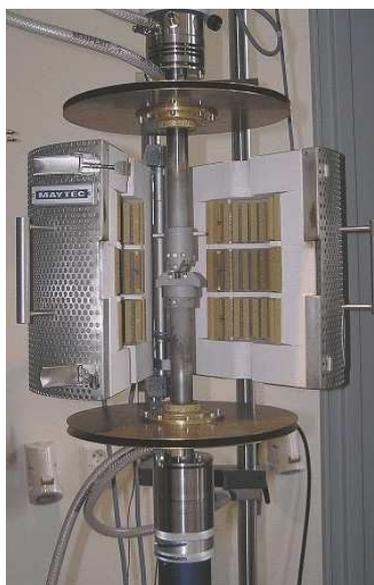
Obr. 27: Zařízení pro zkoušku pevnosti v ohybu
