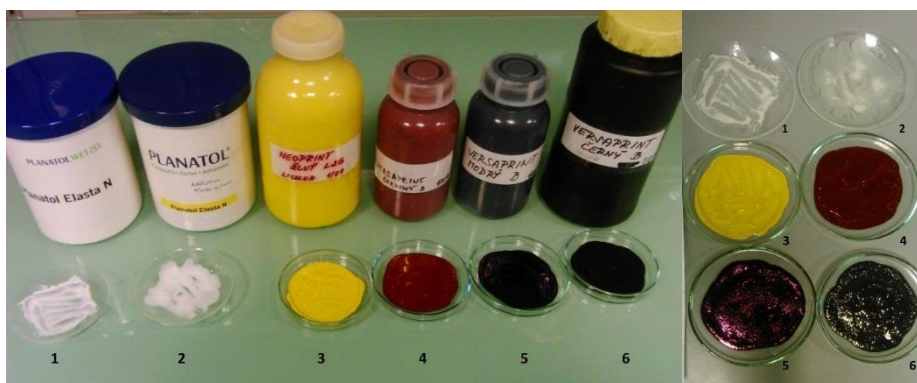
Obrázek 18 Vzorky před a po určování podílu sušiny
