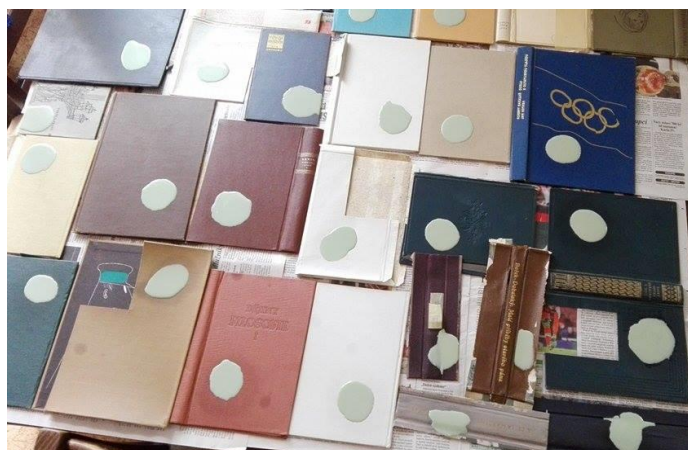
Obrázek 29 Odlévání matric strukturního povrchu z knižních desek
