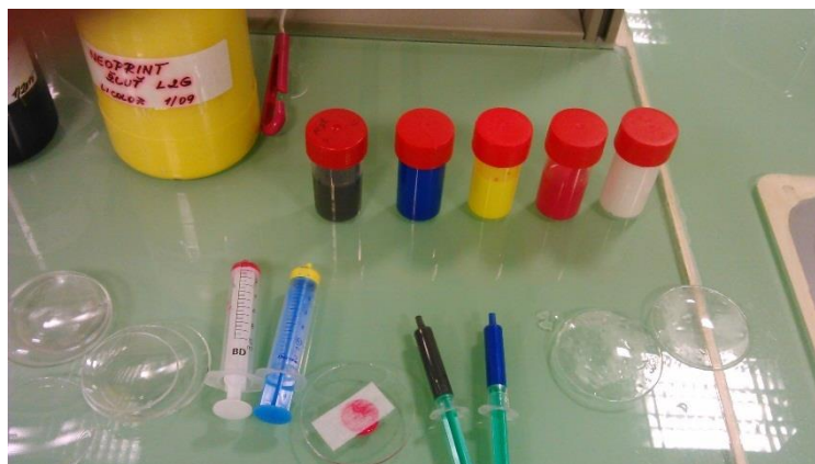
Obrázek 36 Namíchané směsi lepidel pro přípravu kalibračních vzorků
