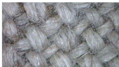
Obrázek 13 Plátňová vazba na fotografii z mikroskopu [16]
