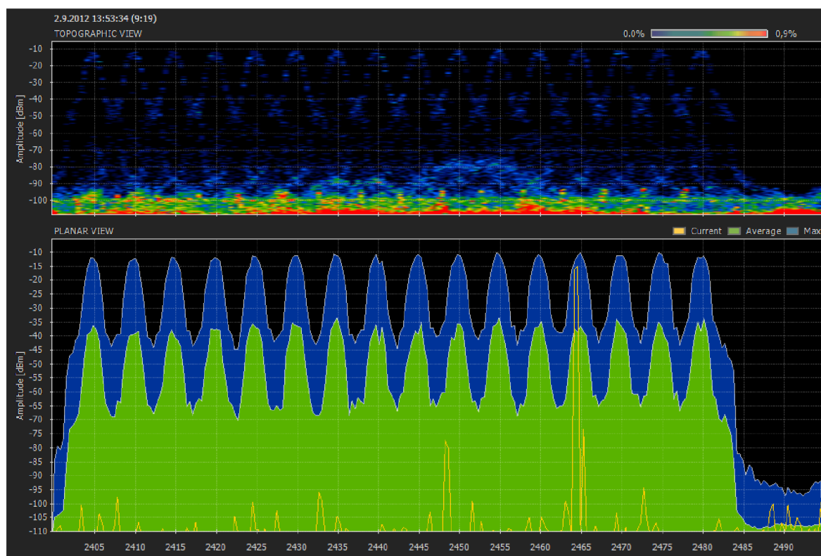
Obrázek 10 - využití 2,4GHz pásma FHSS RC vysílačem
