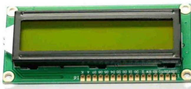
Obr. 3-6 LCD displej s řadičem HD44780
