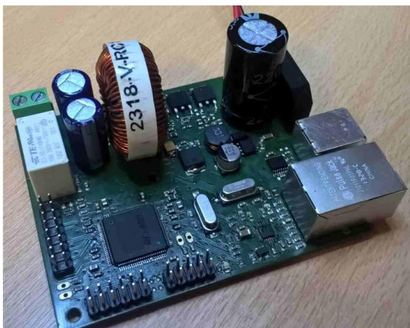
Obr. 5-1 Osazený prototyp laboratorního zdroje
