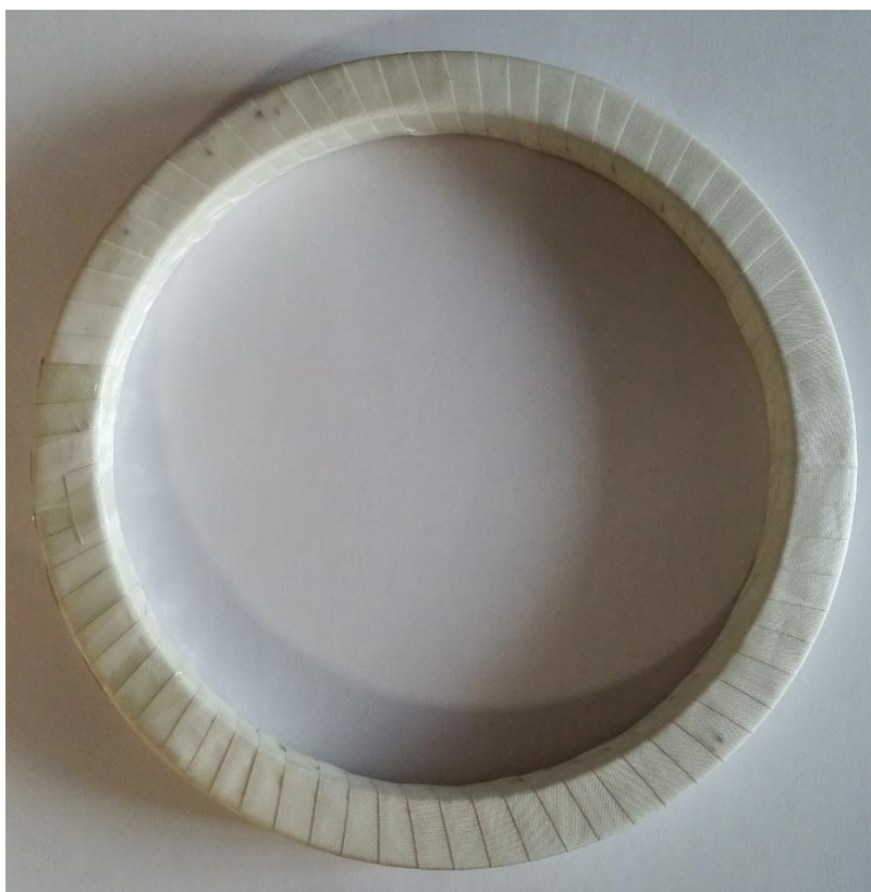
Obr. 35 Amorfní jádro s plastovým pouzdrém a namotanou textilní páskou.
