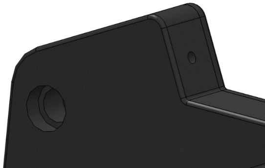
Obr. 28 Detail výstupku krytu LPCT.
