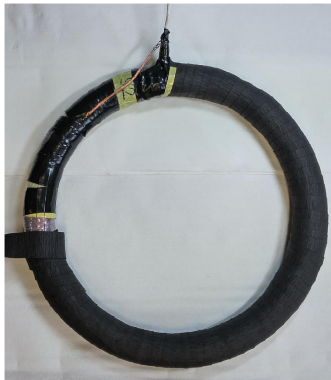
Obr. 46 Motání polovodivé pásky na LPCT.
