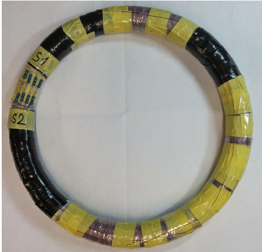
Obr. 43 Připájený odporový bočník LPCT s amorfním jádrem.
