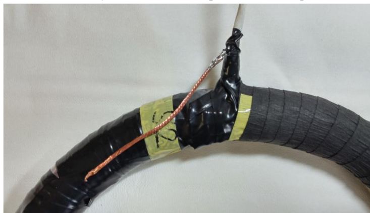
Obr. 45 Detail dracounu a stínění LPCT.
