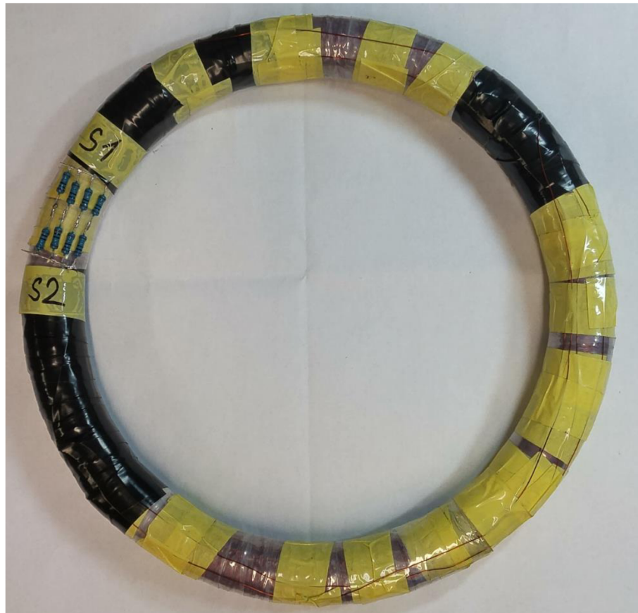
Obr. 43 Připájený odporový bočník LPCT s amorfním jádrem.
