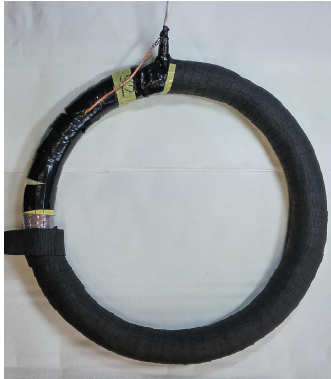
Obr. 46 Motání polovodivé pásky na LPCT.
