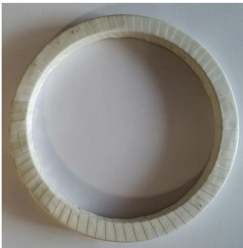
Obr. 35 Amorfní jádro s plastovým pouzdem a namotanou textilní páskou.
