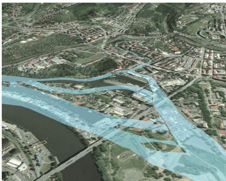
Obr.5.6. 3D vizualizace ortofotomapy a porovnání původního stavu toku Vltavy (vektor ze stabilního katastru z roku 1841) se současným (2005).
