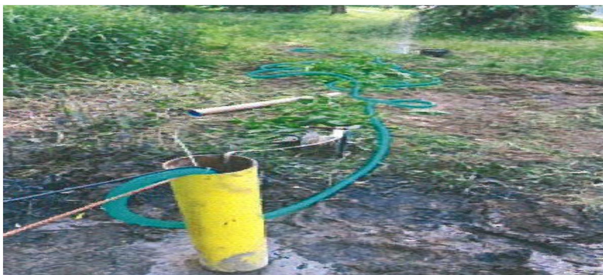
Obrázek č. 16 Vrt při hydrogeologickém průzkumu. Zdroj: NORTHGEO, 2017.
