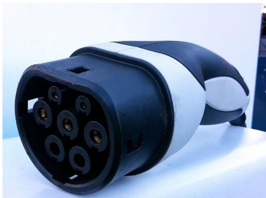
Obrázek 11 Konektor Type 2 Mennekes [53]
