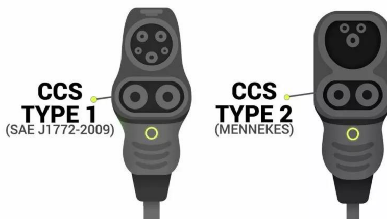
Obrázek 9 Vlevo konektor CCS Type 1, vpravo konektor CCS Type 2 [54]
