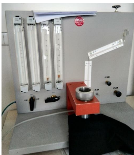
Obrázek 47 Měření prodyšnosti textilií
