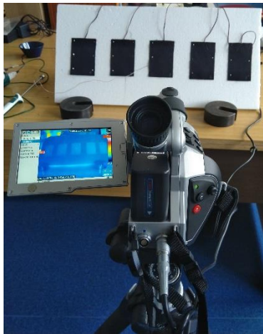
Obrázek 42 Stanovení termokamerou stupně vyhřívání elementu v kombinaci s látkou
