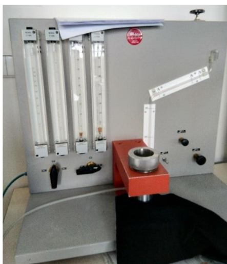
Obrázek 47 Měření prodyšnosti textilií
