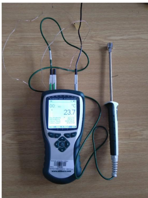
Obrázek 36 Příklad měření teploty povrchu
