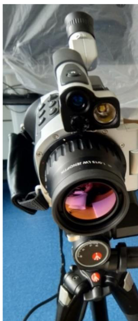
Obrázek 40 Termokamera Vario CAM na změření teploty povrchu
