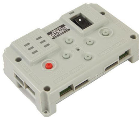
Obrázek 13: Řídící jednotka CM-530 [18]
