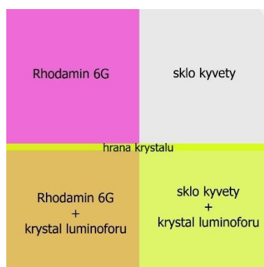
Obrázek 59: Schéma kombinovaného vzorku testovaného v hyperdimenzionálním snimači
