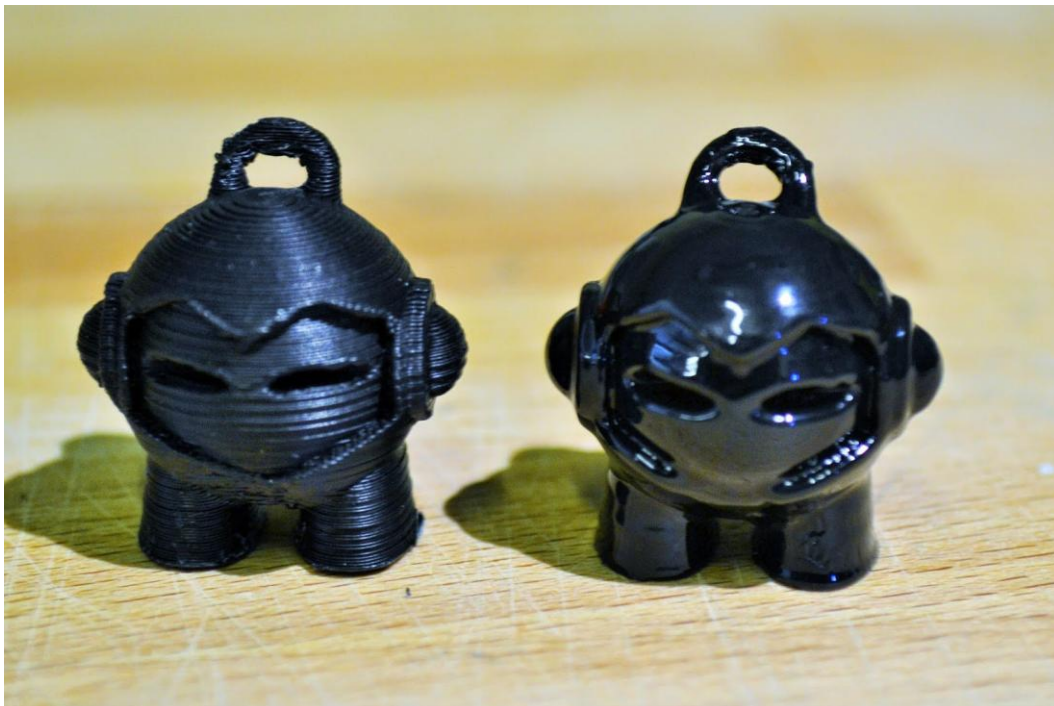
Obr. 7) Súčasť pred a po dokončovacích úprav [10].
