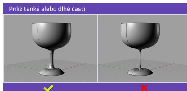
Obr. 3) Príklad príliš tenkej časti [8].
