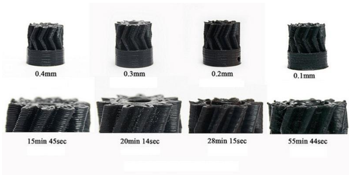
Obr. 18) Príklady kvality výrobku v závislosti na výške vrstvy a doby tlače [23].
