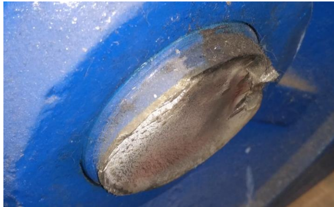
Obr.14 Únavový lom hřídele elektromotoru
