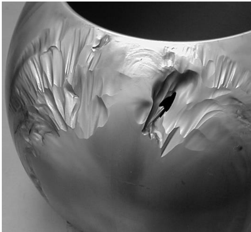
Obr.8 Erozivní opotřebení kulového ventilu [15]
