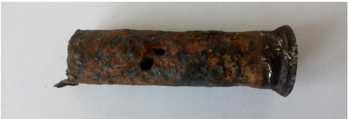
Obr. 15 Korozí znehodnocená součást
