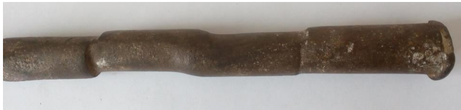
Obr. 12 Deformace čepu z pásového vozidla v důsledku vzniku opotřebení
