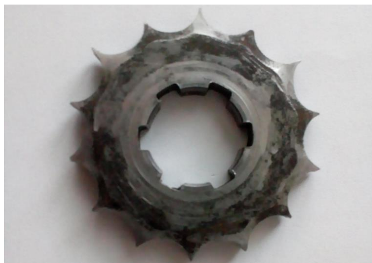
Obr. 6 Abrazivní opotřebení řetězového kola
