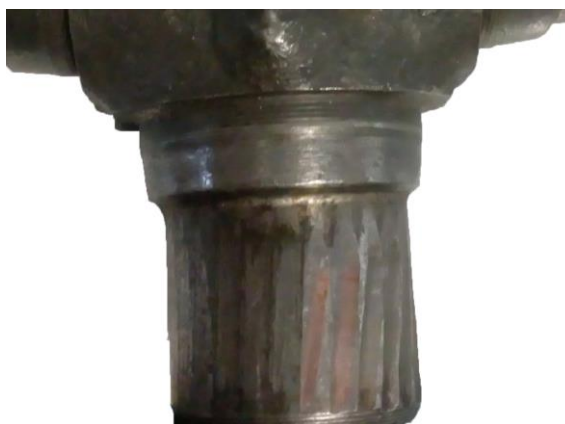
Obr. 3 Vibrační poškození křížového kloub
