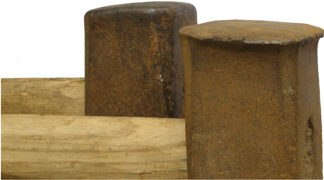
Obr. 17 Napěchování ocelové palice
