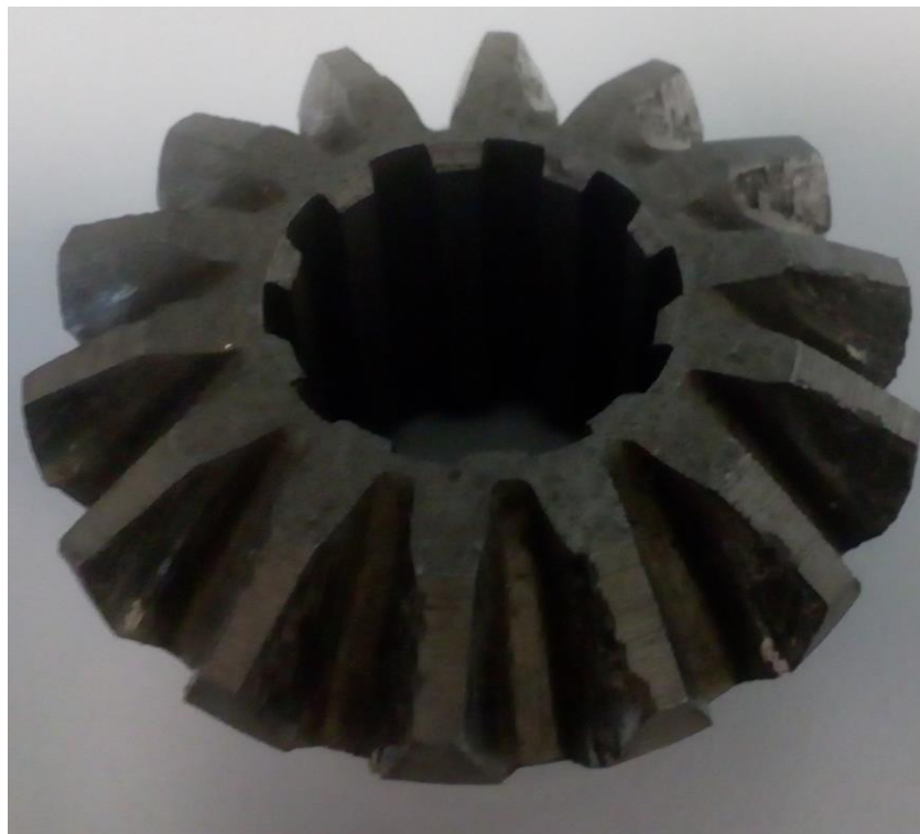
Obr. 10 Pitting boků zubů kuželového kola
