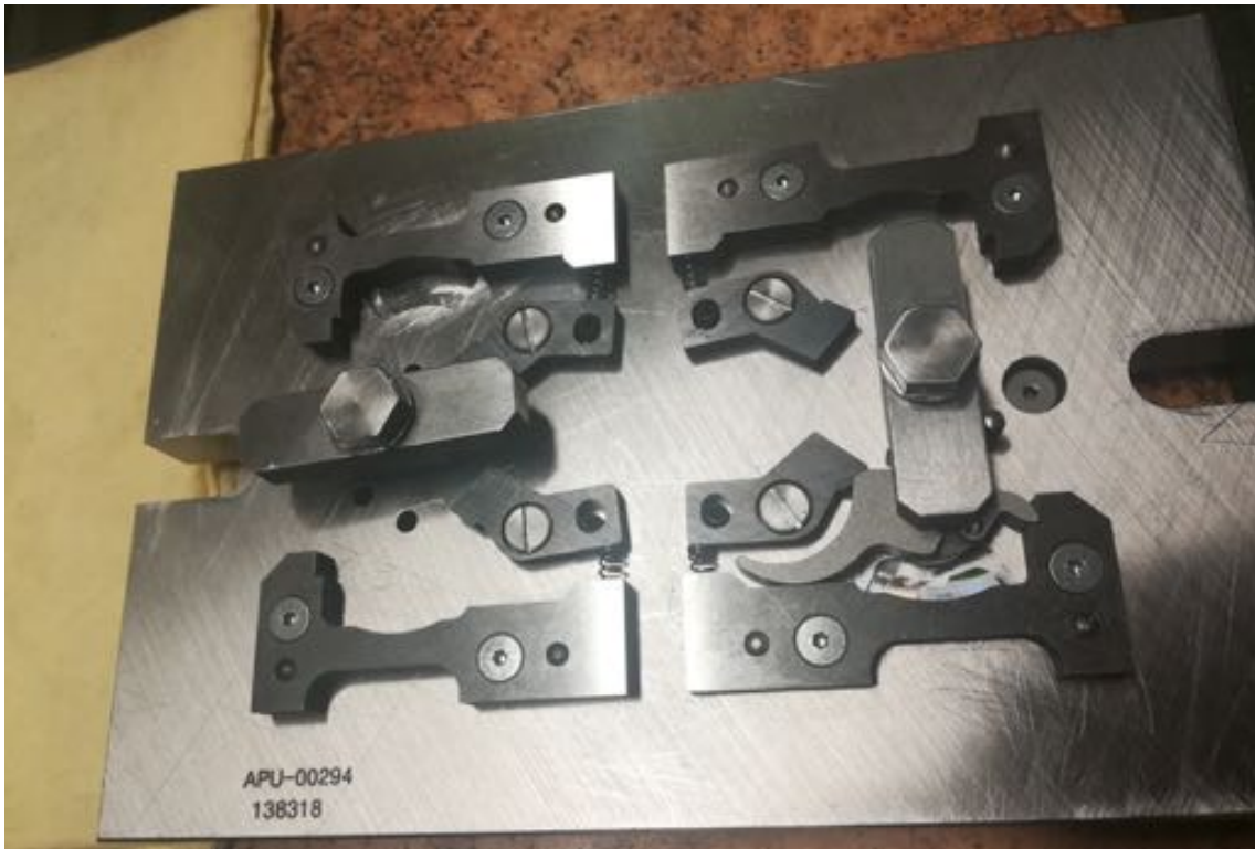
Obr. 3.7 Způsob upnutí spouští do přípravku APU-00294.
