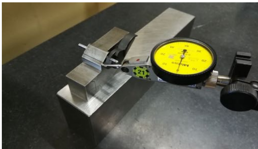
Obr. 4.6 Měření kóty 10,77 \pm 0,05 mm – detail měření.
