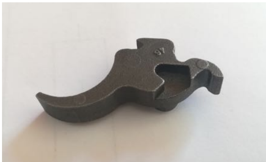
Obr. 2.29 Detail levé boční plochy odlitku spouště.
