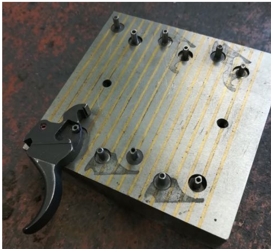
Obr. 2.12 Upnutí spouště za díry v přípravku APU-00019.
