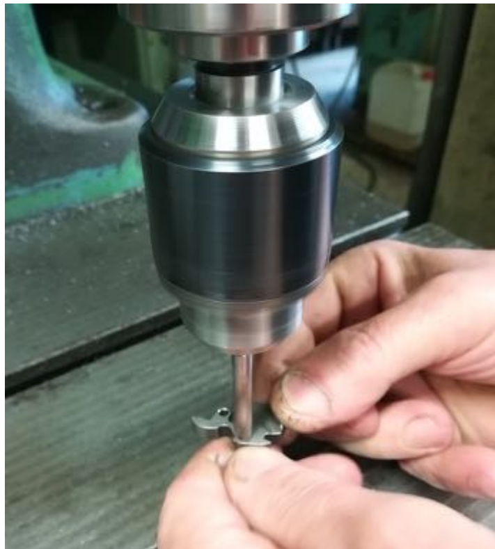
Obr. 2.21 Ruční srážení hran u děr \varnothing 2,5 D9 mm a \varnothing 2,98 H7 mm.
