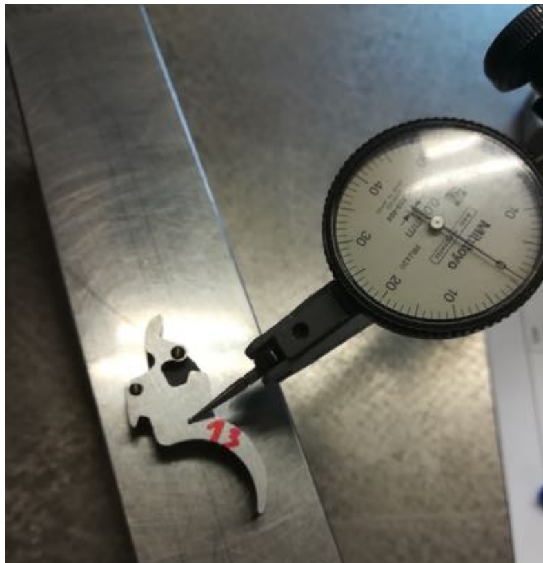
Obr. 4.14 Ověření rovnoběžnosti bočních ploch.
