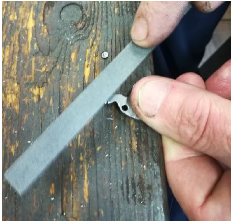
Obr. 2.23 Odstranění ostřin pilníkem.
