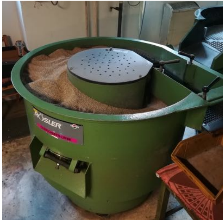
Obr. 2.18 Sušicí stroj Rösler s kukuřičnými zrny.
