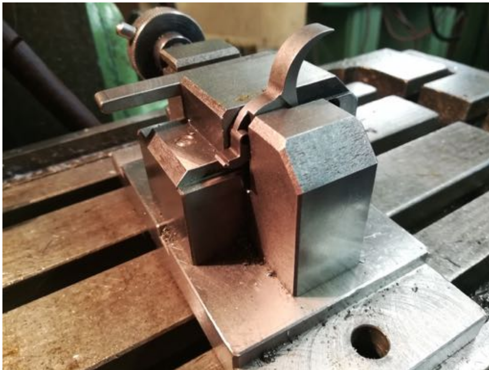
Obr. 2.5 Spoušť upnutá ve speciálním přípravku k frézování záchytu kohoutu.
