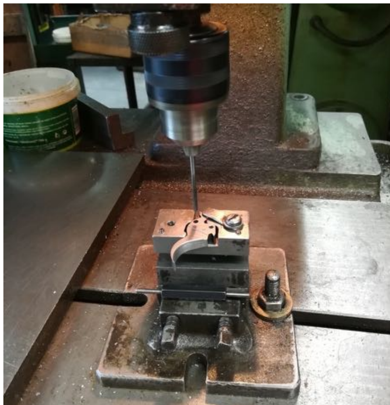
Obr. 2.24 Vystružení díry \varnothing 2,98 H7 mm.
