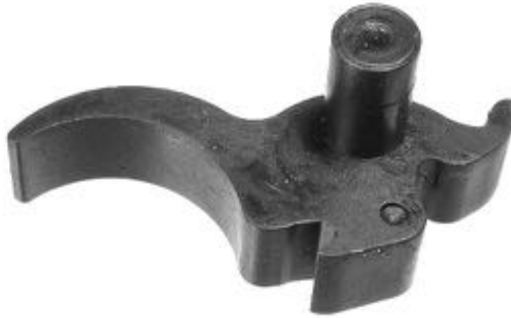
Obr. 2.2 Odlitek spouště se zbytkem vtoku [17].
