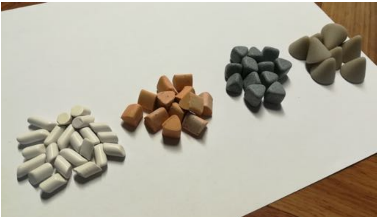
Obr. 2.20 Omílací tělíska, zleva: k dokončování, ke hrubování (Walt), ke hrubování (Walt), ke hrubování (Rösler).
