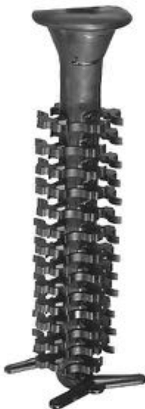
Obr. 3.4 Odlitý stromeček (vtok + 49 spouští) [17].
