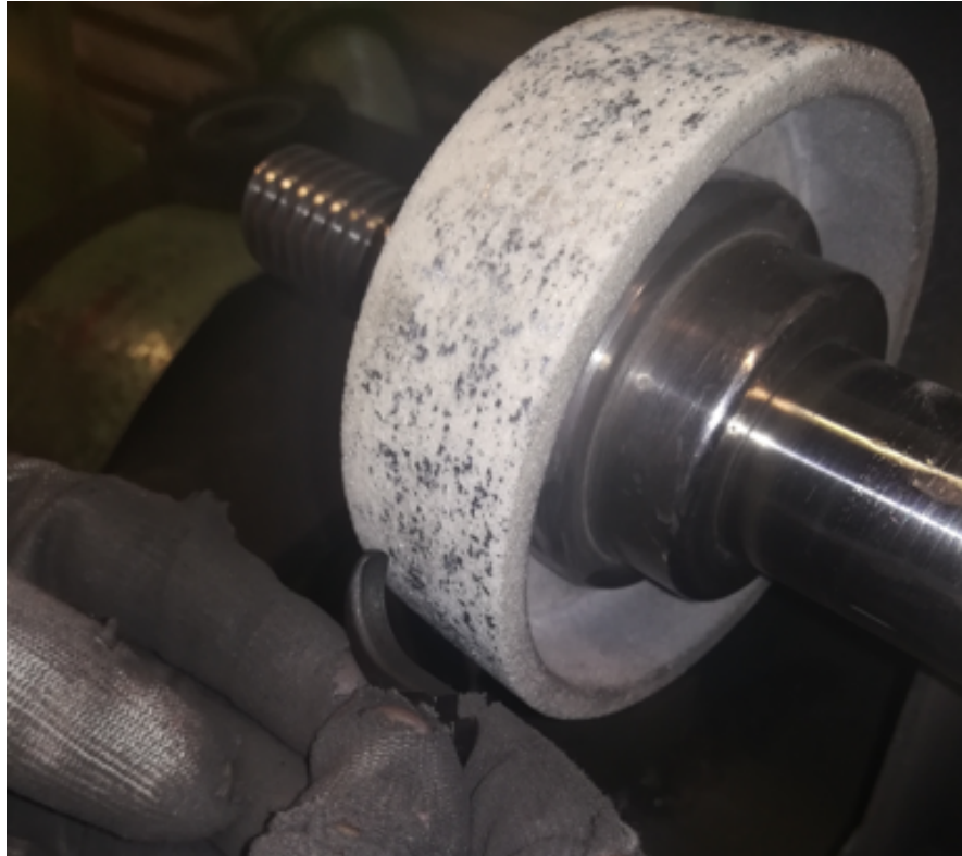
Obr. 2.16 Způsob broušení konce jazýčku spouště keramickým brousicím kotoučem.
