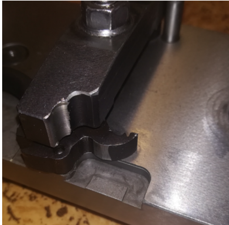
Obr. 2.10 Detail upnutí spouště do CNC přípravku APU-00219.
