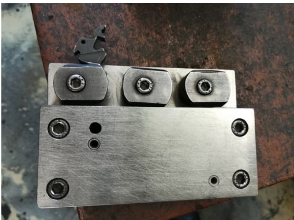
Obr. 3.9 Upnutí spouště ve speciálním přípravku pro broušení tloušťky.
