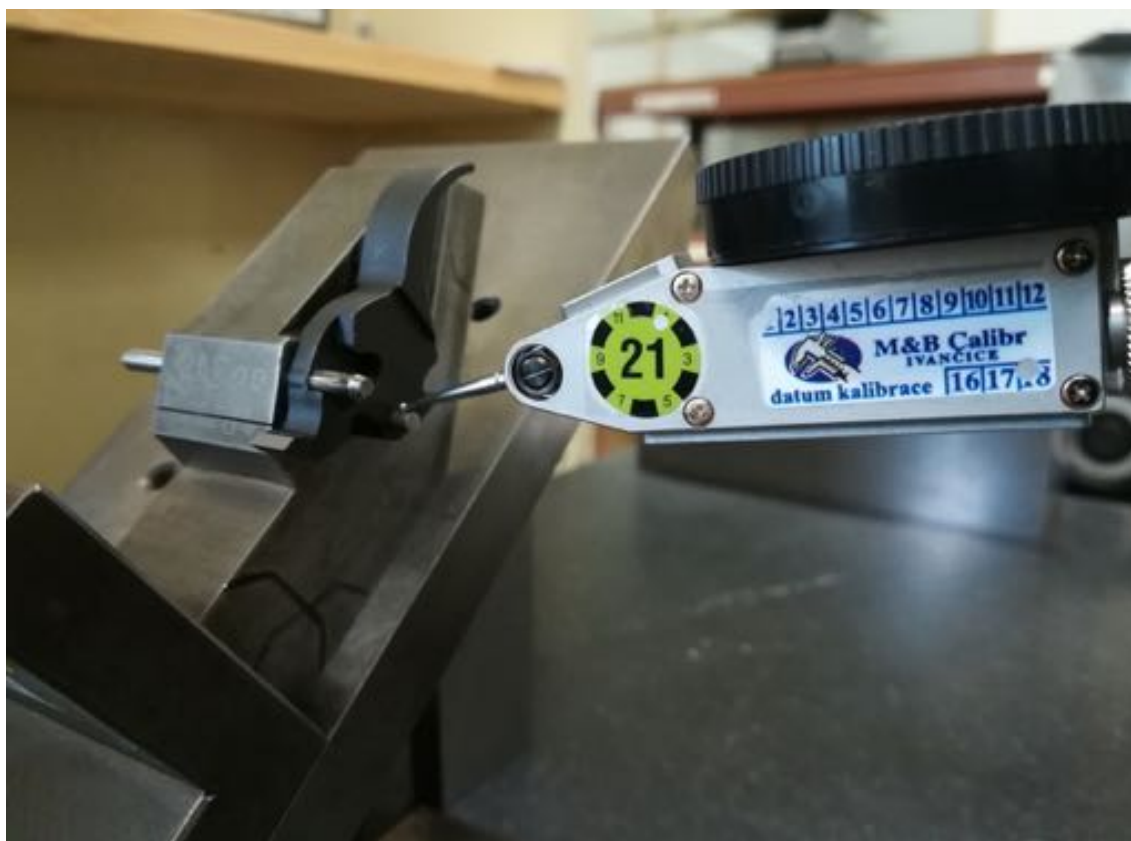
Obr. 4.2 Zaměření vrcholu kolíku.
