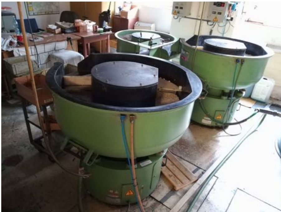
Obr. 2.17 Omílací a sušící stroje Rösler. Hrubovací (vlevo dole), dokončovací (vpravo nahoře) a sušící stroj (uprostřed nahoře) [1].
