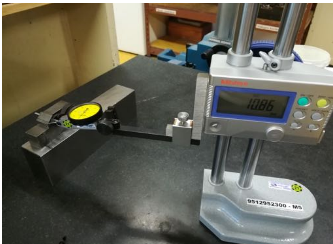
Obr. 4.7 Měření kóty 10,77 \pm 0,05 mm.
