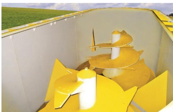
Obrázek 12 – Vertikální míchací systém VS. 2, dvoušnekové provedení.
