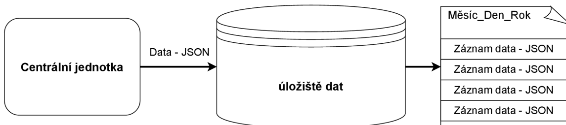
Obrázek 4.5: Schéma úložiště naměřených dat. Data jsou ukládána ve formátu JSON. Jednotlivé záznamy, které centrální jednotka získá od řídicí jednotky, se ukládají do souborů. Každý soubor obsahuje záznamy z jednoho dne a má název ve formátu „Měsíc_Den_Rok“, kde „Měsíc“ je zkratka daného měsíce, „Den“ číslo dne v měsíci a „Rok“ je číslo roku.
