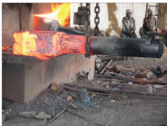
Obr. 2.7 Volné kování rozměrného výkovku [30]
