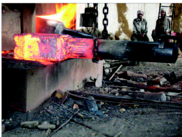
Obr. 2.7 Volné kování rozměrného výkovku [30]
