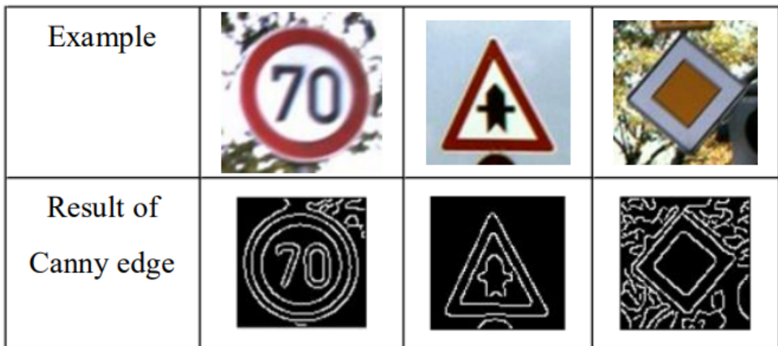
Obr. 3.3: Detekce hran pomocí Cannyho detektoru 2
