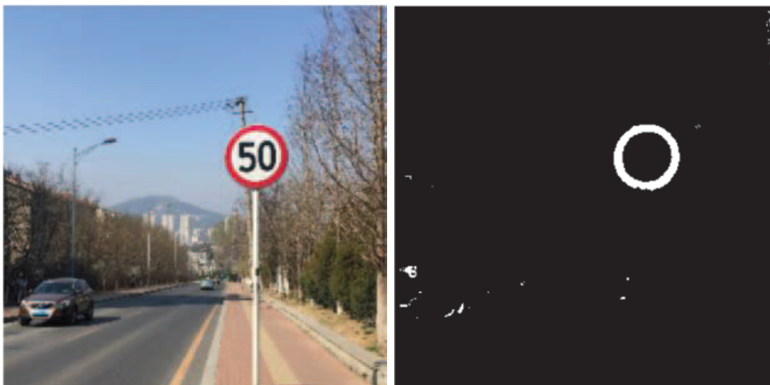
Obr. 3.2: Segmentace podle červené barvy v HSV modelu [7]
