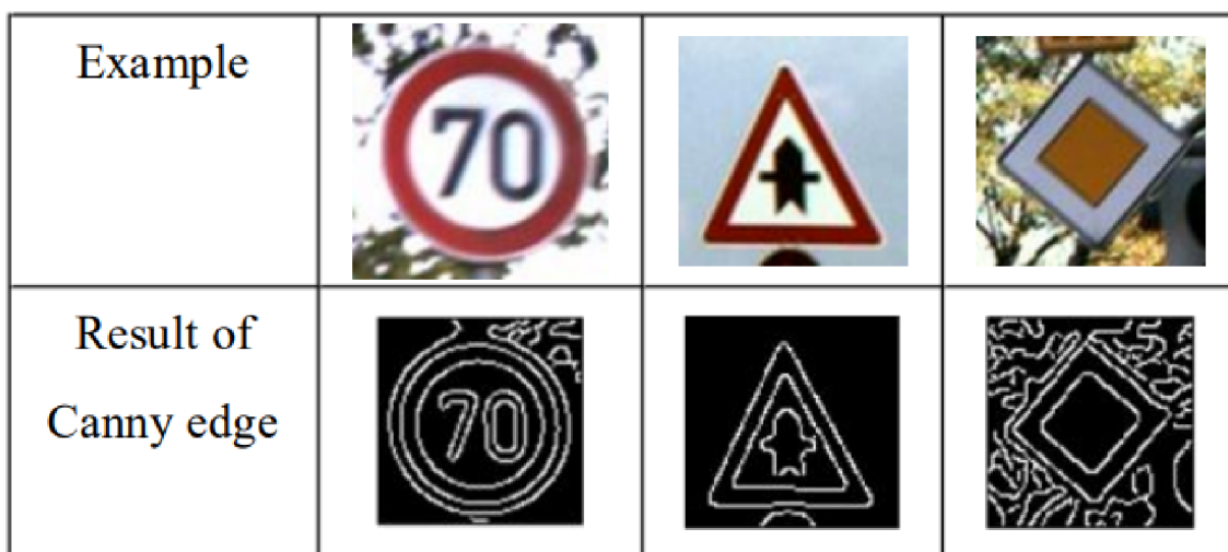
Obr. 3.3: Detekce hran pomocí Cannyho detektoru 2
