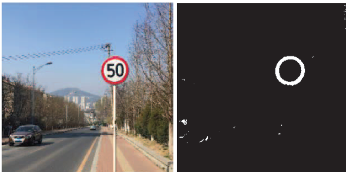
Obr. 3.2: Segmentace podle červené barvy v HSV modelu [7]
