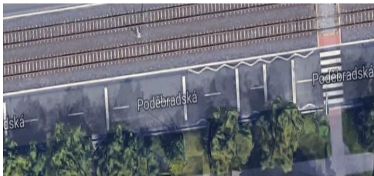
Obr. č. 23: Vodorovná značka V12e a V18 (zdroj: google.cz/maps/@50.1062873,14.5407335,72m/data=!3m1!1e3)
