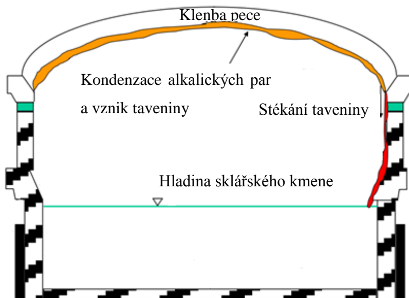
Obrázek 12: Mechanismus koroze dinasové klenby [11]
