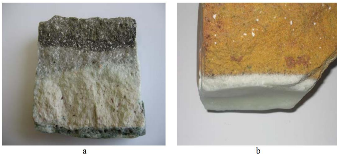
Obrázek 13: Foto použitých dinasových cihel: a) vzorek z klenby sklářské pece, b) vzorek z klenby elektrické vakuové pece [16]
